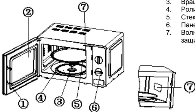
1. Фиксаторы блокировки дверцы
