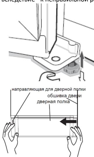
• Когда холодильник будет установлен в окончательное положение, выровняйте его с помощью регулировочных ножек, поворачивая их. Изначально, ножки холодильника полностью закручены. Вы можете раскрутить их руками или с использованием гаечного ключа. В передней части холодильника расположены ножки, а сзади – колеса, чтобы при необходимости можно было легко передвинуть холодильник.
